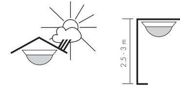
Gerät an einem geschützten Ort montieren bei Deckenmontage auf ca. 2,5 bis 3 m Höhe. Bei der Wahl des Montageortes auf freie Sicht achten, da Infrarot-Strahlen keine festen Gegenstände - auch keine Glasscheiben - durchdringen können.
