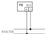
Sämtliche, in Kombination mit dem KNX-Melder verwendbaren Komponenten wie Aktoren, Taster usw. kommunizieren mit dem Melder ausschliesslich über den KNX-BUS.
