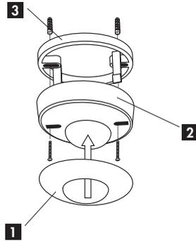
1. Abdeckring abnehmbar mittels Drehung im Gegenuhrzeigersinn
